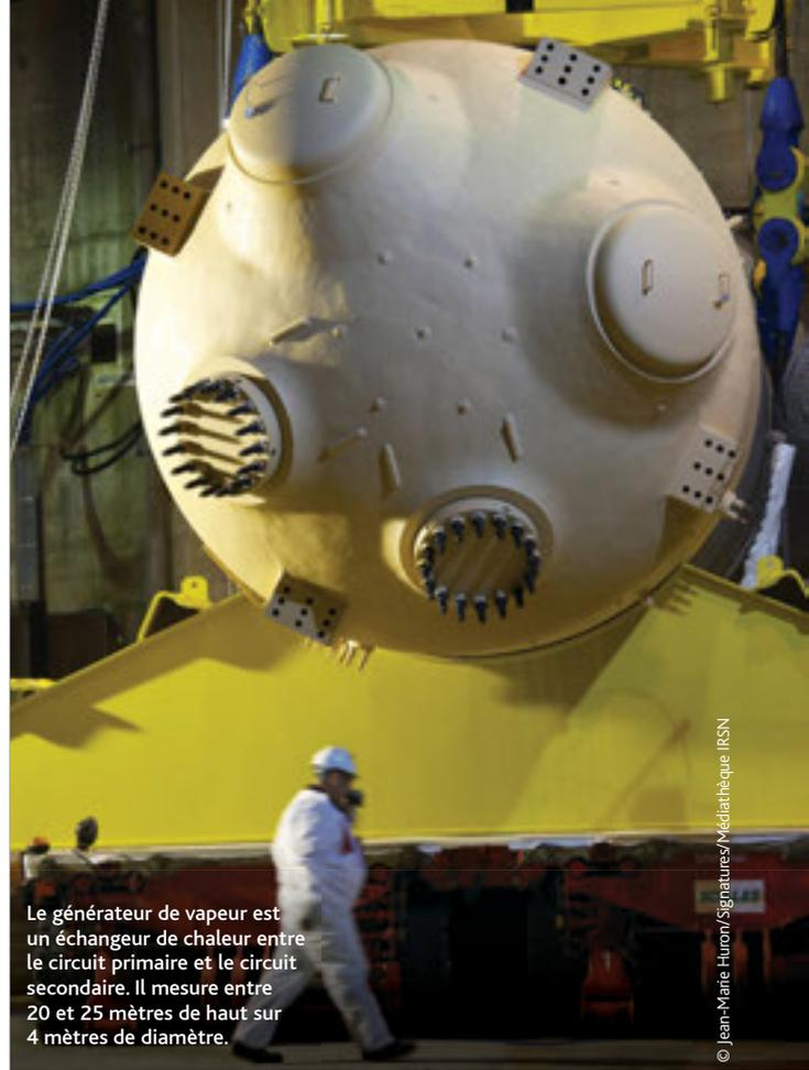
Le générateur de vapeur est un échangeur de chaleur entre le circuit primaire et le circuit secondaire. Il mesure entre 20 et 25 mètres de haut sur 4 mètres de diamètre.
